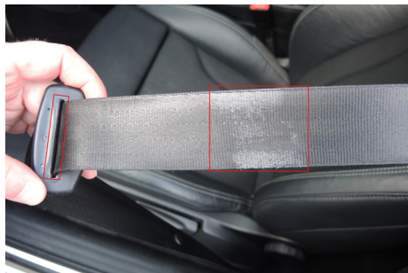
Traces de contrainte sur la boucle de ceinture
